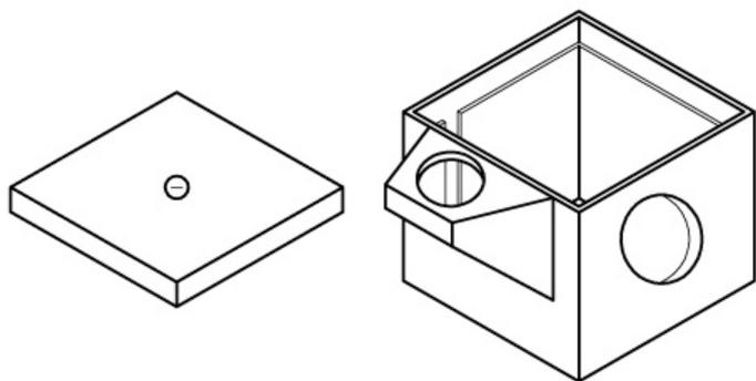
**POZZETTO PLUVIALE 30 X 30 H. 30**
