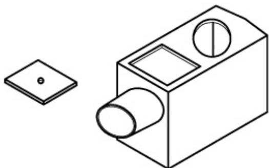
**POZZETTO PLUVIALE 32 X 16 H 24**
