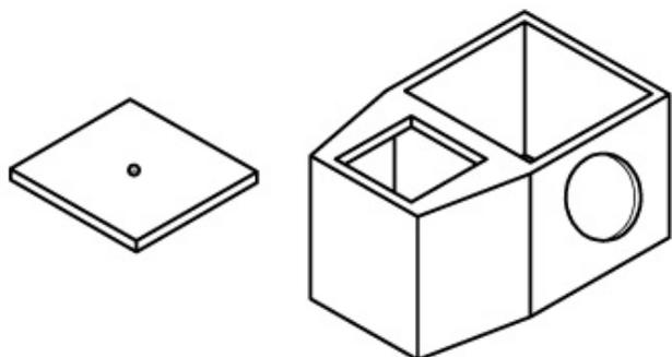
**POZZETTO PLUVIALE 30 X 15 H. 20**
